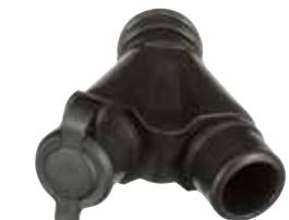
3M™ Vakum Ünitesi Y-Adaptörü, 3M™ Vakum Ünitesinin aynı anda iki vakum aletini desteklemesini sağlar. Kullanıcı iki aleti aynı anda bağlayabilir. Adaptörün dahili sürgülü vanası, yalnızca bir hortum bağlandığında sağlam bir sızdırmazlık sağlar. İki o-ringler, Y-Adaptörü ile vakum ünitesi arasında bir sızdırmazlık oluşturur.
