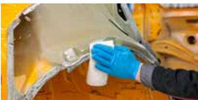
► Sgrassaggio delle aree della flangia di accoppiamento del pannello di alloggiamento
