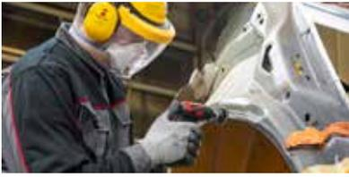
► Rimuovere il materiale rimanente e i contaminanti dal pannello di alloggiamento. Preparare le rimanenti flange di accoppiamento sul pannello di alloggiamento con un disco o nastro abrasivo Scotch-Brite™
