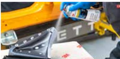
► Appliquez l'apprêt pour revêtement de soudure sur toutes les zones du panneau hôte et du panneau de remplacement nécessitant des opérations de soudure, à l'exception des zones de collage
