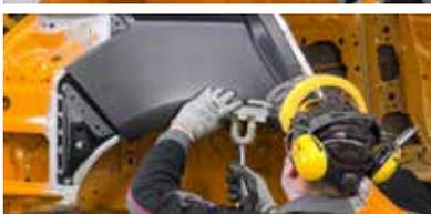
► Installez le panneau de remplacement sur le panneau hôte en effectuant un serrage en place
