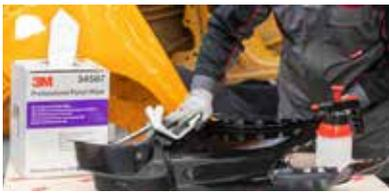
► Dégraissez les brides de jonction du panneau de remplacement
