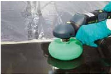
► Geben Sie eine kleine Menge 3M™ Perfect-It™ Schleifpaste Plus Extreme auf ein grünes Schaumstoff-Pad, das auf einem Rotationspolierer montiert ist.
