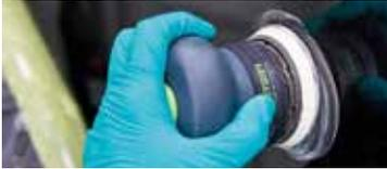
► Nachbearbeitung von Kratzern mit einer 3M™ Trizact™ Feinschleifscheibe 443SA, Körnung 6000, 75 mm auf einem Schwingschleifer.
