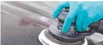
► Schleifen Sie die Fläche mit einer 3M™ Trizact™ Feinschleifscheibe 443SA, Körnung 3000, 150 mm auf einem Schwingschleifer.
