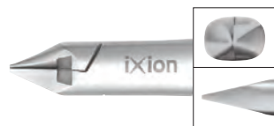
940-809 ライトワイヤー プライヤー (カッター付) 1本 27,000円 屈曲許容範囲: 最小 .012インチ/ 最大 .020インチ 切断許容範囲: 最小 .014インチ/ 最大 .020インチ
