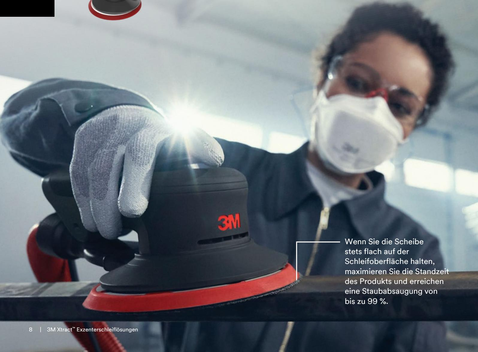
Wenn Sie die Scheibe stets flach auf der Schleifoberfläche halten, maximieren Sie die Standzeit des Produkts und erreichen eine Staubabsaugung von bis zu 99 %.
