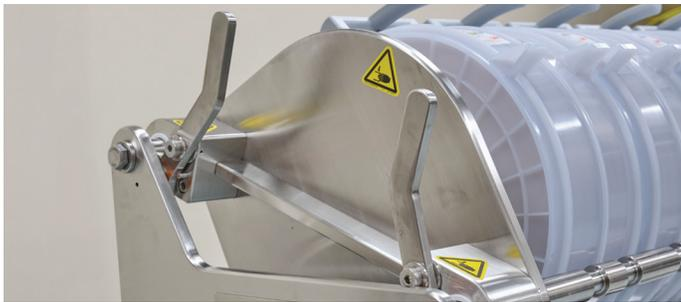
Mécanisme de verrouillage à deux poignées
