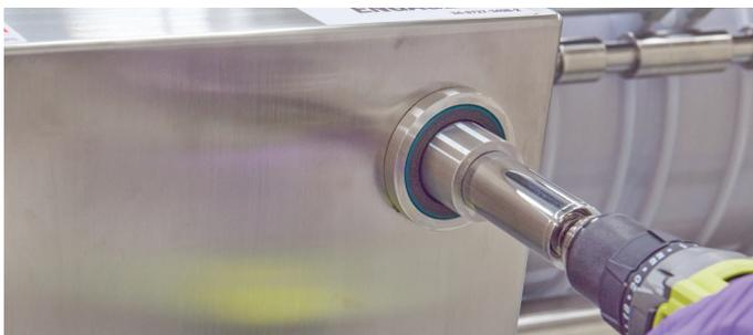
Compatible avec l'adaptateur pour perceuse électrique à la place du levier manuel
