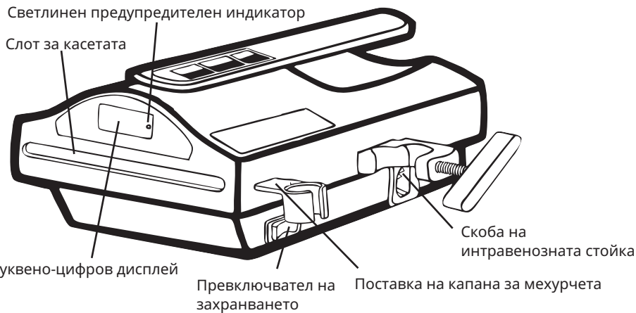
Системата Ranger за затопляне на кръв/течности се състои от затоплящо устройство модел 245 и стерилен комплект за затопляне.
