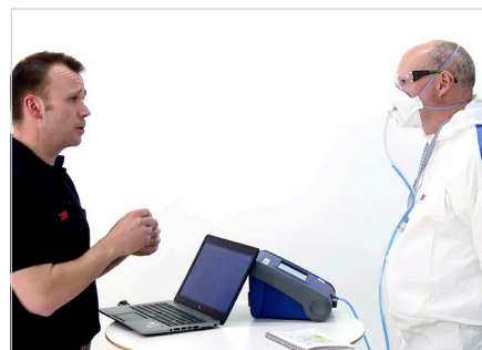
Rysunek 1. Liczenie cząstek w otoczeniu – TSI® PortaCount® Model 8038 jest wykorzystywany do ilościowego testu dopasowania (QNFT) w przypadku użytkownika noszącego półmaskę filtrującą.
