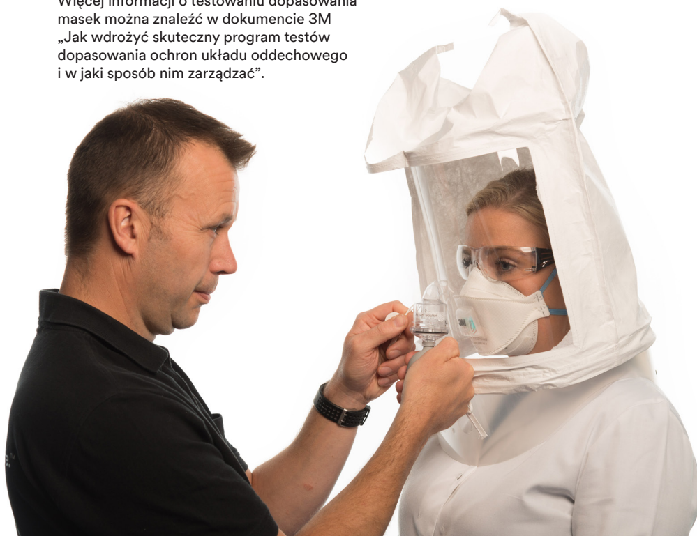
Rysunek 3. Zestaw testowy 3M FT-30 Bitrex® używany do jakościowego testu dopasowania (QLFT) w przypadku użytkownika noszącego półmaskę filtrującą.
