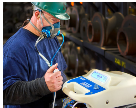
Rysunek 2. Podciśnienie kontrolowane – OHD® Qantifit® służy do ilościowego testu dopasowania (QNFT) w przypadku użytkownika noszącego półmaskę wielokrotnego użytku. Zdjęcie: dzięki uprzejmości OHD®.
