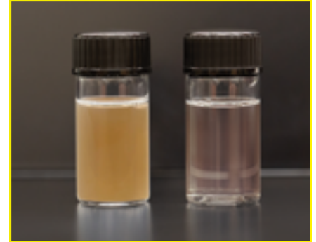
Avant et après l'utilisation de la Capsule de récolte RC 3M MC : réduction de la turbidité en une seule étape
