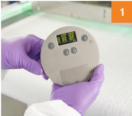
1 Valide las condiciones de la cámara de curado UV.
