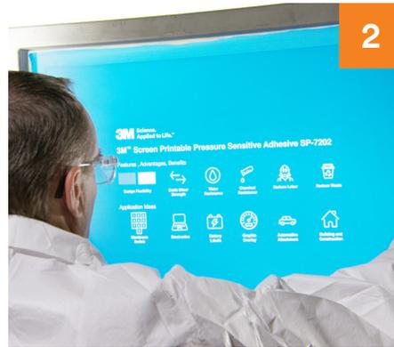
2 Inspeccione e instale la plantilla.
