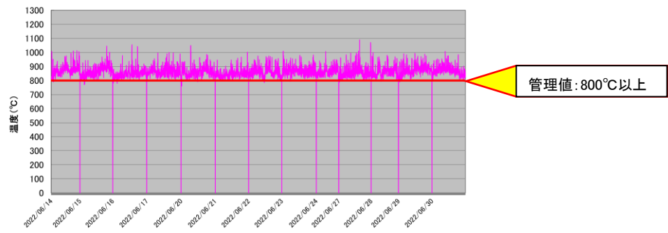
焼却炉 2次燃焼炉温度 (2022年6月)
