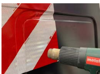
Verwarm tot \pm 40^{\circ}\text{C} om de folie zachter te maken
