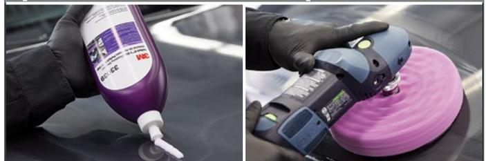
Elimina los microrayones del lijado 8000 y aporta un acabado brillante.
