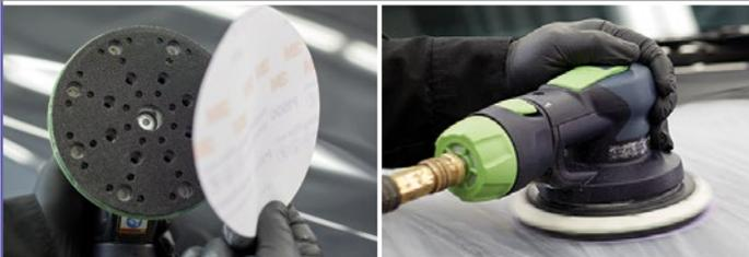
Se utiliza para eliminar la suciedad y nivelar el exceso de textura de la superficie en áreas grandes o pequeñas.
