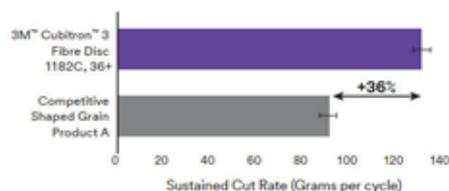
Acier carbone : l'allégation de la « vitesse de coupe soutenue » est déterminée en faisant la moyenne des cycles de coupe 7 à 20 (soit 14 minutes de meulage). Les barres d'erreur représentent les résultats avec un niveau de confiance de 95 %.
