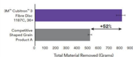
Acier inoxydable : l'allégation de « matière totale retirée » est déterminée en faisant la moyenne de la quantité de métal meulé pendant la durée totale de l'essai (10 cycles ou 10 minutes de meulage). Les barres d'erreur représentent les résultats avec un niveau de confiance de 95 %.
