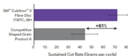
Acier inoxydable : l'allégation de la « vitesse de coupe soutenue » est déterminée en faisant la moyenne des cycles de coupe 3 à 6 (soit 4 minutes de meulage). Les barres d'erreur représentent les résultats avec un niveau de confiance de 95 %.
