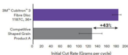
Acier inoxydable : l'allégation de la « vitesse de coupe initiale » est déterminée en faisant la moyenne des cycles de coupe 1 et 2 (les deux premières minutes de meulage). Chaque cycle de la méthode de test correspond à 1 minute de temps de meulage. Les barres d'erreur représentent les résultats avec un niveau de confiance de 95 %.
