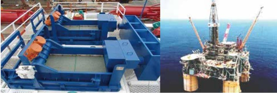
图6: 采用3M™ Scotch-Weld™增韧环氧树脂胶粘剂,将碳纤维复合板粘结在不锈钢上,以用于轻质石油振动器。
