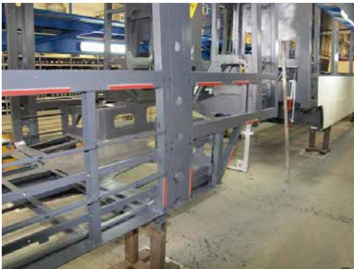
图5: 使用3M™胶粘密封剂将GRP面板粘合到钢材上
