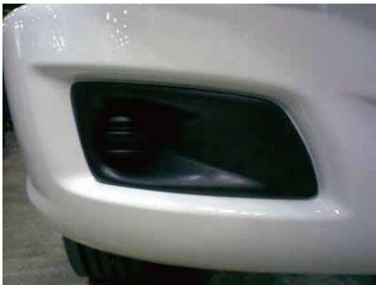
图3: 使用3M™ Scotch-Weld™结构胶,将ABS与玻纤填充的聚丙烯粘合起来
