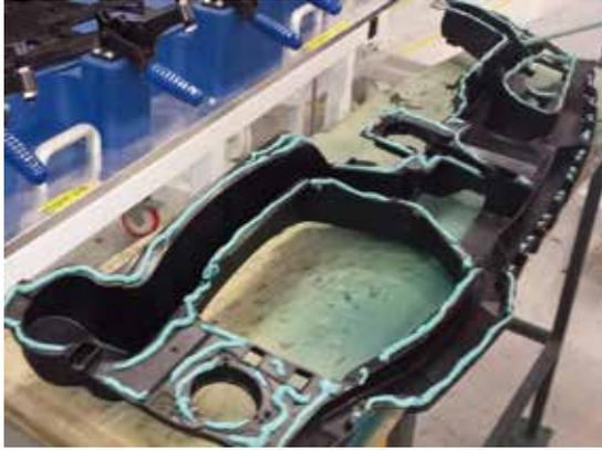
图4: 用3M™ Scotch-Weld™ DP8010NS结构塑料粘接胶 将轻质玻纤填充聚烯烃散装头模具粘合在铝框上
