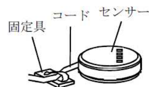
図1 センサーの布設
