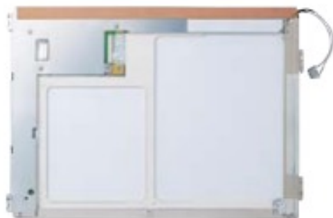
LCDユニットのシールドイング (3M™ 導電性テープ)
