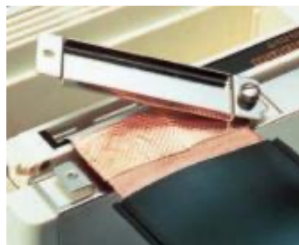
シールド型フラットケーブルのグラウンディング (3M™ 導電性テープ)
