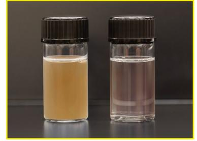
*Avant et après l'utilisation du Clarificateur chromatographique de récolte RC 3M<sup>MC</sup> : réduction de la turbidité en une seule étape.*
