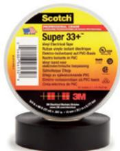
Ruban électrique vinyle de qualité professionnelle pour certains de vos travaux d'entretien et de réparation électriques les plus exigeants. Hautement conformable, ultra-extensible et résistant aux intempéries ; résiste aux rayons UV, à l'abrasion, à la corrosion, aux alcalis et aux acides. Le ruban est applicable par températures allant de -18 °C à 38 °C sans affecter les propriétés physiques.
