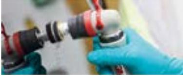
► Éliminez les grains de poussières avec le disque à support film 3M™ Finesse-It™ Trizact™, 32 mm grain 3000 monté sur l'outil prévu à cet effet.
