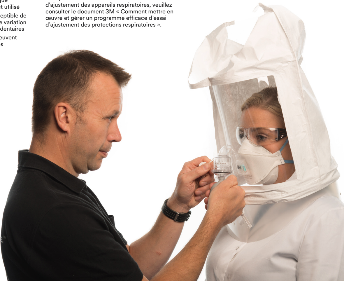
Figure 3. Kit d'essai d'ajustement 3M FT-30 Bitrex® utilisé pour effectuer un essai d'ajustement qualitatif sur un sujet portant un masque respiratoire filtrant
