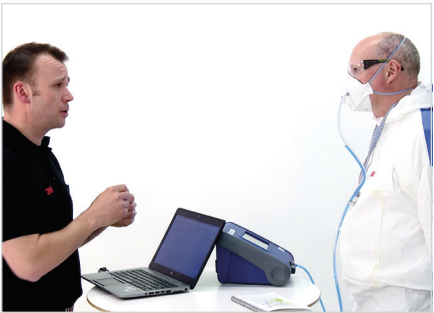
Figure 1. Comptage des particules ambiantes – TSI® PortaCount® modèle 8038 utilisé pour effectuer un essai d'ajustement quantitatif sur un sujet portant un masque respiratoire filtrant
