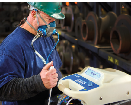
Figure 2. Pression négative contrôlée – OHD® Quantifit® utilisé pour effectuer un essai d'ajustement quantitatif sur un sujet portant un masque réutilisable. Image : avec l'aimable autorisation de OHD®
