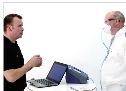
Figura 1. Recuento de partículas en el ambiente: TSI® PortaCount® modelo 8038 que se utiliza para realizar una prueba de ajuste cuantitativa (PACN) en un sujeto que usa una mascarilla con filtro
