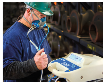
Figura 2. Presión negativa controlada: se utiliza OHD® Quantifit® para realizar una prueba de ajuste cuantitativa (PACN) en un sujeto que usa media máscara reutilizable. Imagen: cortesía de OHD®
