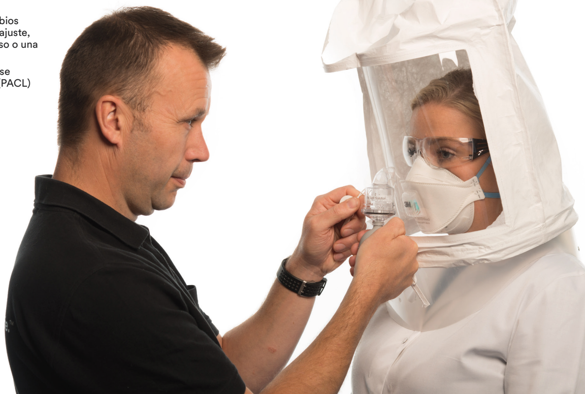
Figura 3. Kit de prueba de ajuste Bitrex® FT-30 de 3M que se utiliza para realizar una prueba de ajuste cualitativa (PACL) a un sujeto que usa una mascarilla con filtro
