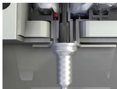
Fig. 15: Después de la primera carga el PENTAMATIC abrirá en forma automática la bolsa de aluminio con las púas ajustadas en la cavidad
