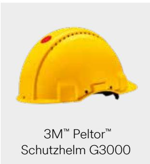
Dieser Schutzhelm ist mit 3M™ Peltor™ Uvicator™ Sensor ausgestattet. Dieser zeigt an, wann der Helm ausgetauscht werden muss. Der kurze Schirm gewährt eine ausgezeichnete Sicht, mehr Lüftungsschlitze als bei konventionellen Helmen sorgen für eine optimierte Lüftung und die weiche, runde Form verringert die Gefahr, dass der Helm an Ästen o. ä. hängenbleibt.
