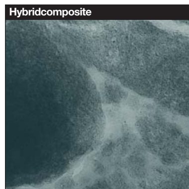
Hybridcomposite Hohe Stabilität, aber geringe Oberflächen-Glätte: Herkömmliches Hybridcomposite unter dem Elektronenmikroskop. Bei einer mittleren Größe von 1 µm sind die einzelnen Partikel hier nahezu formatfüllend.
