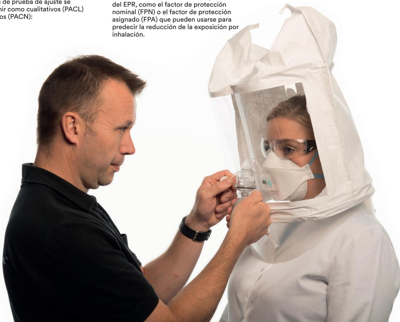
Figura 1 - Kit de prueba de ajuste cualitativa y Kit de prueba Bitrex® FT-30 de 3M que se utiliza para realizar una prueba de ajuste cualitativa (PACL) a un sujeto usando una mascarilla autofiltrante
