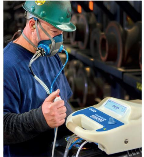
Figura 3 - Presión negativa controlada: PNC OHD® Quantifit® mediante el método REDON que se utiliza para realizar una prueba de ajuste cuantitativa (PACN) en un sujeto que usa una mascarilla con filtro. Imagen: cortesía de OHD®
