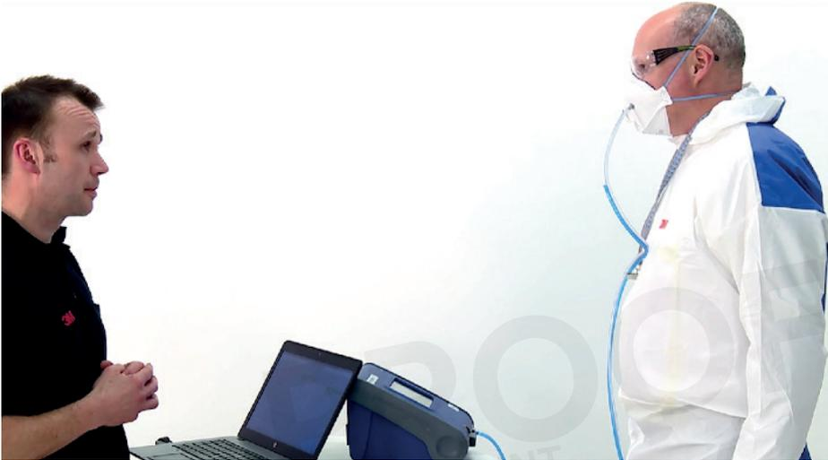
Figura 2 - Recuento de partículas en el ambiente: TSI® PortaCount® modelo 8038 que se utiliza para realizar una prueba de ajuste cuantitativa (PACN) en un sujeto que usa una mascarilla con filtro
