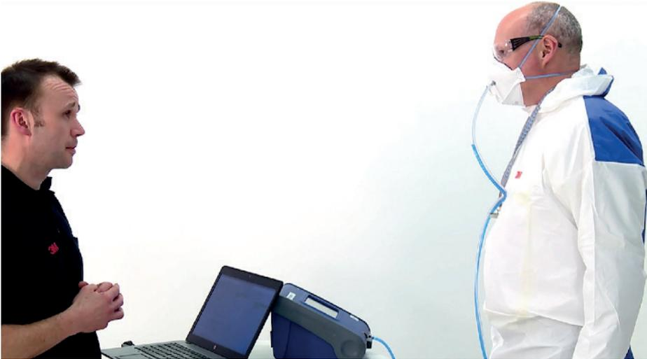
Figure 2 - Comptage des particules ambiantes - TSI® PortaCount® modèle 8038 utilisé pour effectuer un essai d'ajustement quantitatif (QNFT) sur un sujet portant un masque respiratoire filtrant
