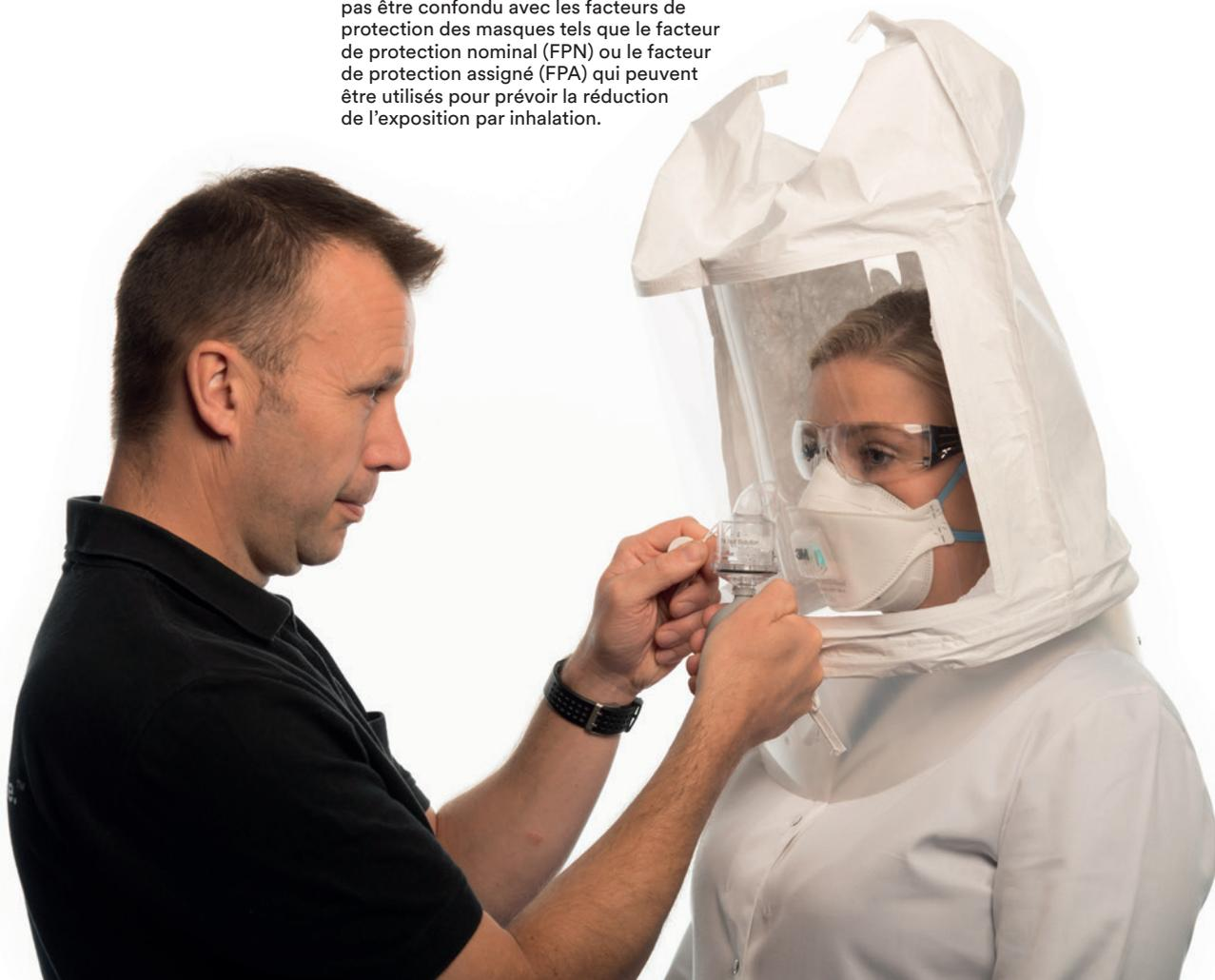
Figure 1 - Kit d'essai d'ajustement 3M FT-30 Bitrex® utilisé pour effectuer un essai d'ajustement qualitatif (QLFT) sur un sujet portant un masque respiratoire filtrant
