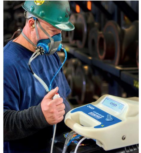
Figure 3 - Pression négative contrôlée - OHD® Quantifit® CNP utilisant la méthode REDON employée pour effectuer un essai d'ajustement quantitatif (QNFT) sur un sujet portant un masque respiratoire filtrant. Image : avec l'aimable autorisation de OHD®
