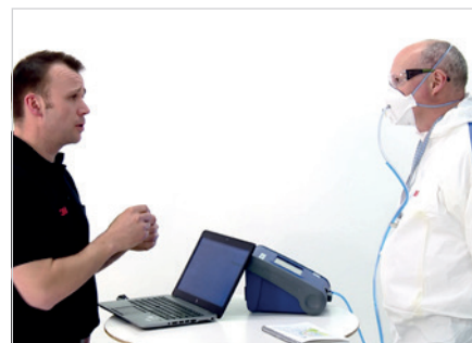
Afbeelding 1. Meting van luchtdeeltjes – de TSI PortaCount® model 8038 wordt gebruikt om een kwantitatieve pasvormtest (QNFT) uit te voeren op iemand met een gelaatsmasker met filter.
