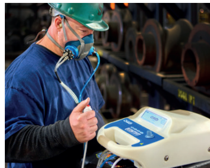
Afbeelding 2. Gecontroleerde negatieve druk – de OHD® Quantifit® wordt gebruikt om een kwantitatieve pasvormtest (QNFT) uit te voeren op iemand die een herbruikbaar masker draagt. Afbeelding: afkomstig van OHD®
