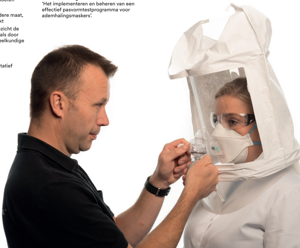
Afbeelding 3. De 3M™ Qualitative Fit Test Apparatus Kit and Bitrex® Pasvormtestkit wordt gebruikt om een kwalitatieve pasvormtest (QLFT) uit te voeren op iemand met een gelaatsmasker met filter.
