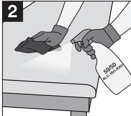
La surface dont le Ruban de gainage isolant VentureClad<sup>MC</sup> 3M<sup>MC</sup> sera appliquée dessus, devrait être nettoyé avec une lingette sans charpie et une solution de 50 % eau et 50 % d'alcool isopropylique.
