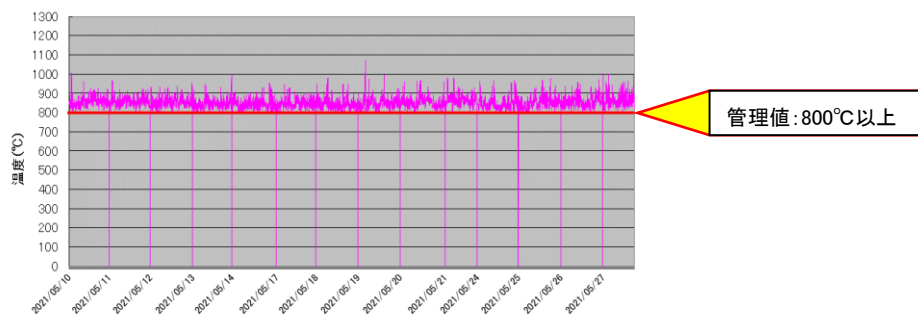
焼却炉 2次燃焼炉温度 (2021年5月)
