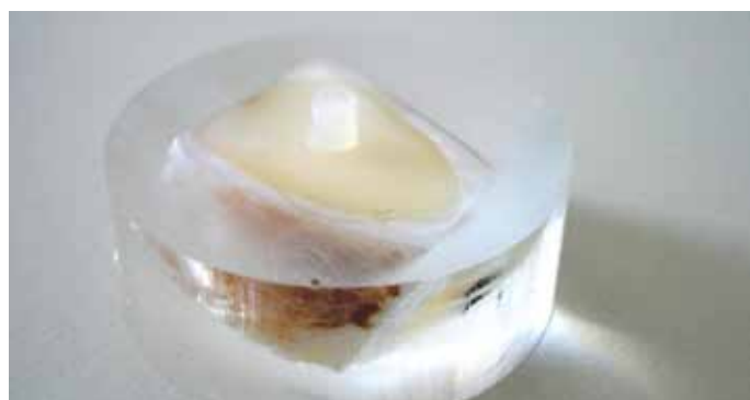
Fig. 4: Campione per test di resistenza al taglio dell'adesione in conformità con la norma ISO 29022:2013 (su dentina bovina)
