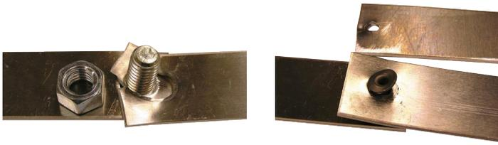
Figure 5. Défaillance de l'aluminium T6061 de 1,6 mm (0,063 po) d'épaisseur et des rivets lors de l'application de la force de traction par rapport à l'aluminium lié avec un adhésif.
