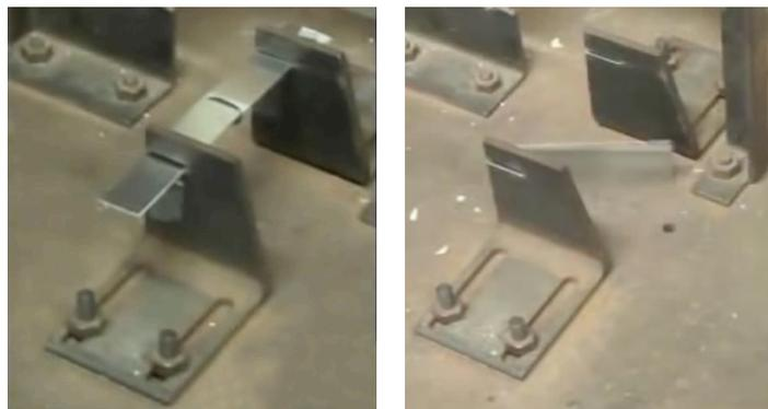
Figure 4. Liaison de l'époxyde renforcé par rapport à la liaison d'une soudure par points, aluminium T6061, d'essai aux chocs de pendule (poids de 1,36 kg [3 lb] sur un bras articulé de 50,8 cm [20 po]) [Youtube.com/watch?v=CPR28olqf5Y](https://www.youtube.com/watch?v=CPR28olqf5Y)
