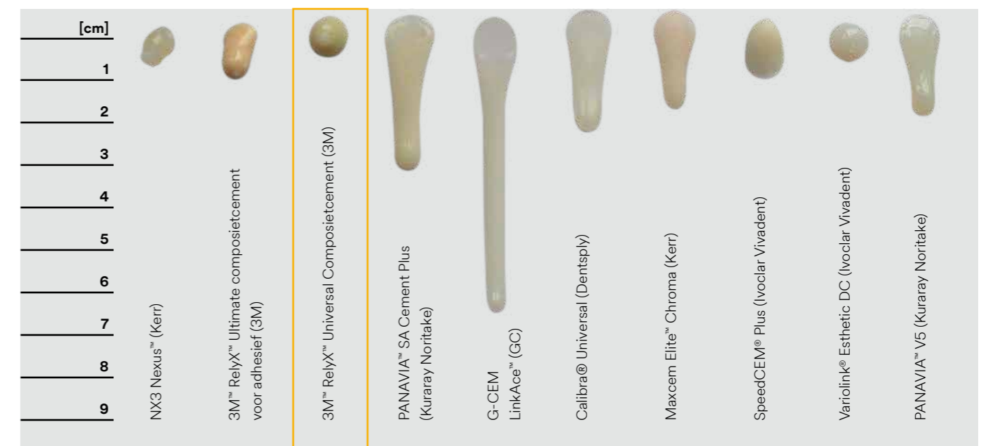
Afb. 2: Om de vloeibaarheidseigenschappen te vergelijken werd van elk cement een even grote hoeveelheid aangebracht op een mengblok dat voordat het cement met licht was uitgehard gedurende 2 minuten rechtop werd geplaatst bij 36 °C.
