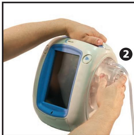
2. Connecter la tubulure du réservoir à la tubulure du pansement en joignant les connecteurs (3).
