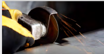
À la main avec un disque à tronçonner
