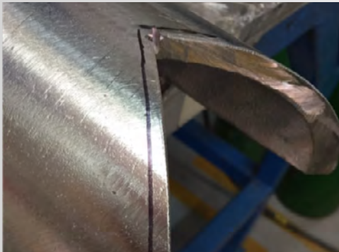
Préparation de la soudure marquée
