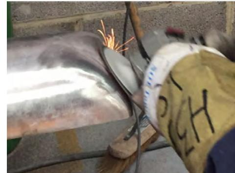
*Soldadura eliminada, superficie entera alisada*
