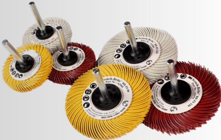
El disco Bristle radial Scotch-Brite™, que incorpora el grano abrasivo cerámico patentado de 3M™ y cerdas moldeadas y flexibles, proporciona un mayor contacto con la superficie que los cepillos metálicos y mantienen sus propiedades abrasivas a lo largo de la vida útil del disco. Nuestros discos rápidos eliminan pintura, manchas, adhesivos, quemaduras de soldaduras, corrosión, óxidos pesados y contaminantes superficiales de áreas de gran tamaño.
