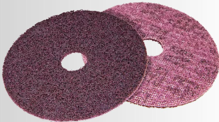
El disco Scotch-Brite™ Surface Conditioning se ofrece en una amplia variedad de granos y tamaños y es el primer paso ideal antes de la limpieza, homogeneización, desbarbado y acabado. La construcción duradera de fibras no tejidas se adapta bien a superficies irregulares o contorneadas sin ni dañar ni producir hendiduras en el material base.
