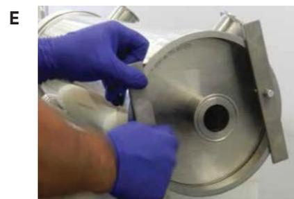
**F** 10 mmレンチを使用して、ねじを回転させてください。2つのねじを交互に1回転ずつ回してください。
