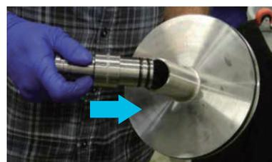
**D** エンドキャップ-カートリッジ接続部をカートリッジへ入れ込み、ハウジングの内側の溝にまで十分に押しこんでください。ハウジングにエンドキャップを押し込むのに、必要であれば樹脂製のハンマーで軽くたたいてください。
