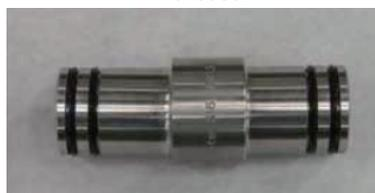
**注:**エンドキャップには、エンドキャップとカートリッジを接続するステンレスの部品（エンドキャップ-カートリッジ接続部品）がついています。この部品はカートリッジを引き抜く際にエンドキャップと共に抜かれるか、もしくはカートリッジの中に残った状態となります。カートリッジの中の残った接続部品は引き抜いてください。
