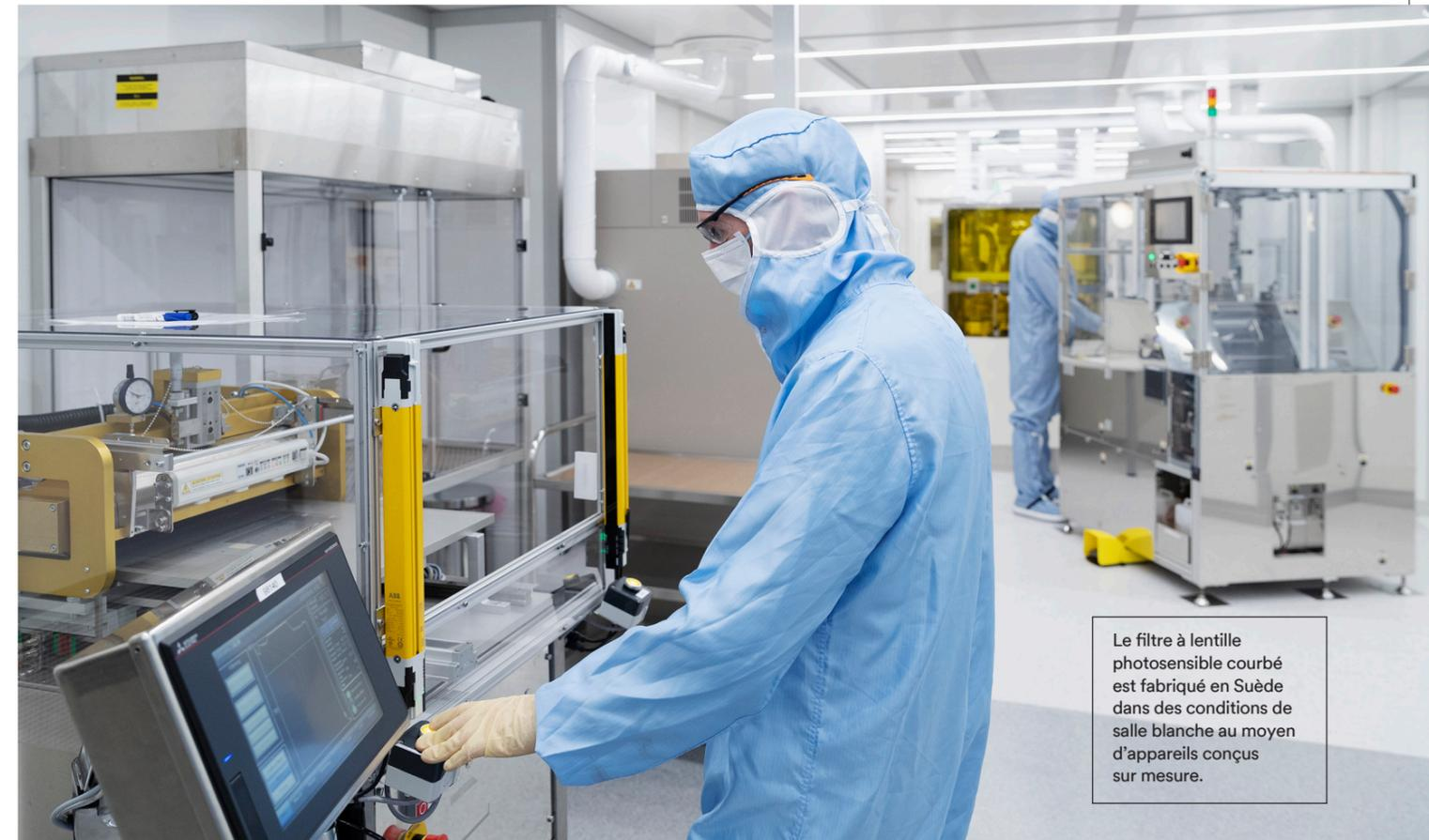
Le filtre à lentille photosensible courbé est fabriqué en Suède dans des conditions de salle blanche au moyen d'appareils conçus sur mesure.
