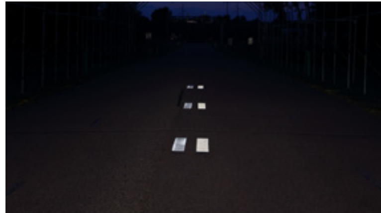
Odblaskowość w klasach RW (po lewej) oraz RR (po prawej) w warunkach ciągłego opadu deszczu
