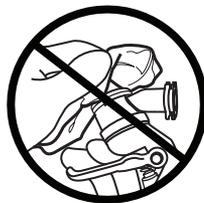
Ikke dynk sprøytepipstolen i løsningsmiddel.
