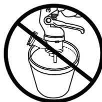
Ikke tørk sprøytepipstolen med en klut dynket i løsningsmiddel: vri ut overflødig væske.
