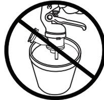
Não limpe a pistola pulverizadora com um pano embebido em solvente; extraia o excesso.
