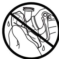
Ikke bruk metallverktøy til å rengjøre luftdekselhullene, for det kan lage skraper som kan ødelegge sprøytemønsteret.
