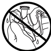
Brug ikke metalredskaber til at rengøre hullerne i luftdyseholderen, da det kan ridse dem – ridser kan ændre sprøjtemønstret.
