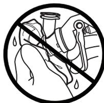
Gebruik geen metalen gereedschap om de gaten in de luchtkap te reinigen aangezien dit krassen aan kan brengen en krassen kunnen het spuitpatroon vervormen.
