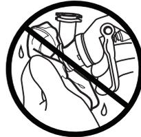
Não utilize utensílios metálicos para limpar os orifícios da tampa de ar, pois pode riscá-los; os riscos podem alterar o padrão de pulverização.
