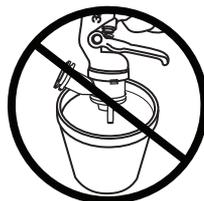
Non strofinare la pistola a spruzzo con un panno eccessivamente imbevuto di solvente; strizzarlo per eliminare il solvente in eccesso.
