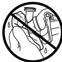
Verwenden Sie zum Reinigen der Luftkappenöffnungen keine Metallwerkzeuge, da sie dabei verkratzt werden könnten. Kratzer können das Strahlmuster stören.
