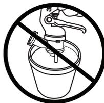
N'essuyez pas le pistolet de pulvérisation avec un chiffon imbibé de solvant ; tordez le chiffon préalablement pour l'essorer.
