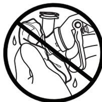
N'utilisez aucun outil métallique pour nettoyer les orifices du support de buse à air, vous risqueriez de les rayer. Les rayures risquent de déformer le jet de pulvérisation.
