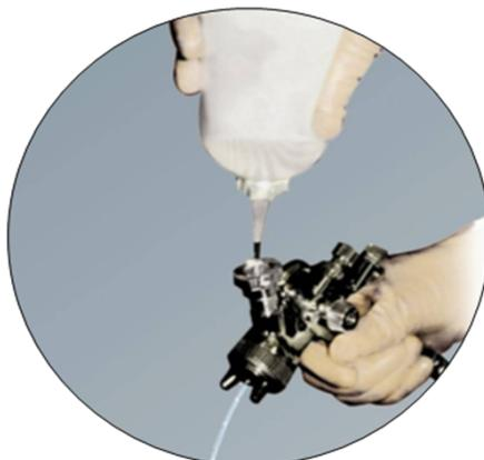
**Промывать надо только покрасочный пистолет и переходник. Это простая операция, не требующая дорогостоящего оборудования и большого количества растворителя.**
