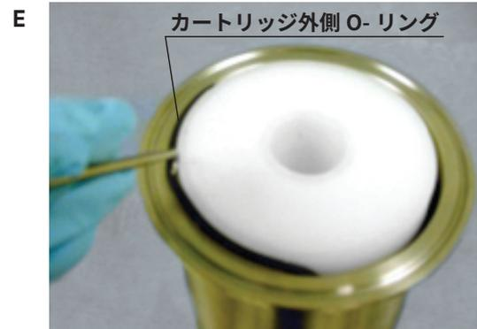
**注：**外側のO-リングは取り外す際に損傷する可能性が高いため、廃棄してください。[注：再利用不可]
