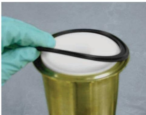
**K** 注：エンドキャップを挿入する前に、2つのセンターO-リングがセンターノズルに正しく装着されていることを確認してください。
