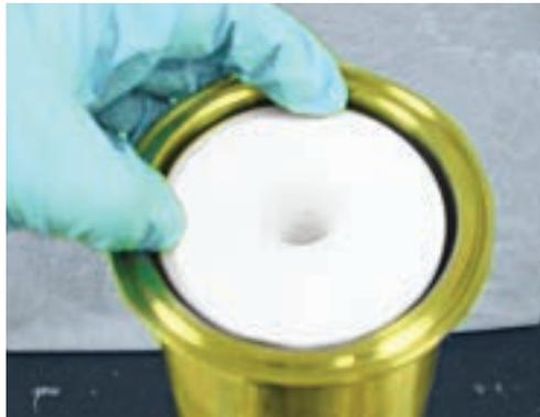
**E** インサートツール (大) をカートリッジと外側O-リングの上に設置します。
