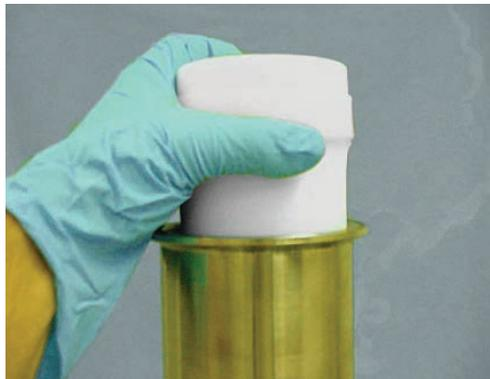
**D** カートリッジ端部の溶着部にカートリッジ外側O-リングを設置します。
