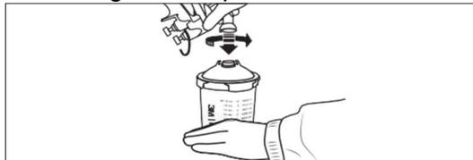
4. Une fois que le pistolet de pulvérisation est correctement assemblé, vous pouvez connecter l'arrivée d'air.
