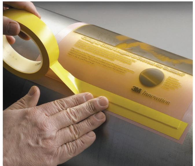
Para sellar la placa contra la penetración de tintas y solventes, que pueden debilitar la fuerza de la cinta de montaje, la cinta de aluminio 425 3M™ (izquierda) y la cinta de vinilo 4613M™ se aplican fácilmente al contacto y se conforman al borde de la placa.
