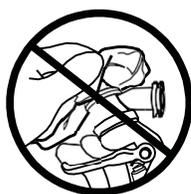
Non immergere l'aerografo nel solvente
