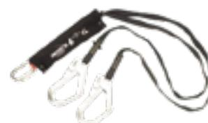
Sangle de jambe double avec sanglage Kevlar® et mousqueton acier 1/4 de tour AJ514 (ouverture 17 mm) et 2 crochets pour échafaudage grande ouverture AJ595 (ouverture 50 mm).
