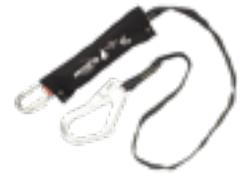
Einstrangig mit Gurtband aus Kevlar® und AJ514 Twist-Lock-Karabiner aus Stahl, 17 mm Öffnungsweite und AJ595 Stahl-Gerüsthaken mit 50 mm Öffnungsweite.
