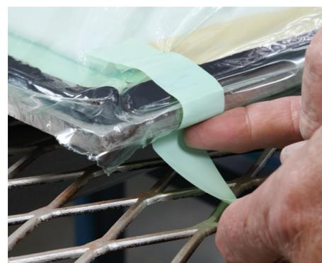
Adatto all'esterno dell'area del sacco a vuoto per trattenere / posizionare in modo sicuro i pannelli di strato laminato, i materiali del sacco a vuoto e le valvole e tubi di connessione termica, fornendo al contempo la rimozione pulita dai telai dopo il ciclo di polimerizzazione.
