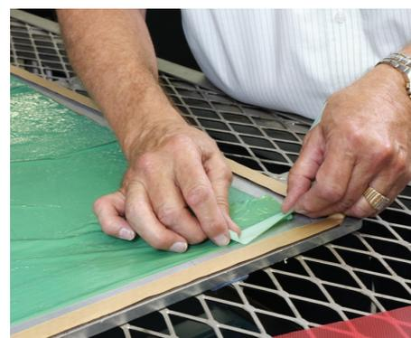
Adatto all'interno dell'area del sacco a vuoto per trattenere / posizionare in modo sicuro i pannelli di strato laminato, i materiali del sacco a vuoto e le valvole e tubi di connessione termica, fornendo al contempo la rimozione pulita dopo il ciclo di polimerizzazione.
