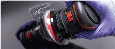
► Rifinire la superficie con il disco di finitura fine 3M™ Trizact™ 443SA, grana P5000, 76 mm con levigatrice rotorbitale.
