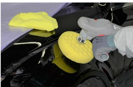
► Sostituire il tampone con uno giallo e applicare una piccola quantità di pasta abrasiva fine 3M™ Perfect-It™ Extra-Fine Plus sul tampone.
